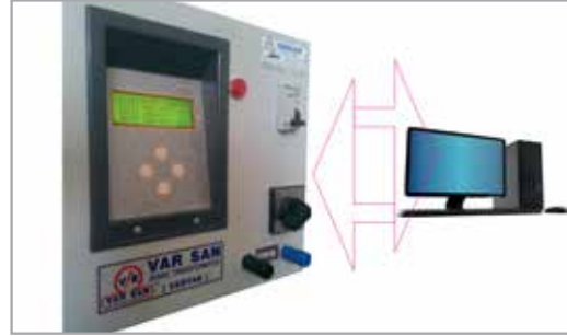
Modbus protokolü ile mesafe sorunu olmadan PC ile voltaj ve akım kontrolü
